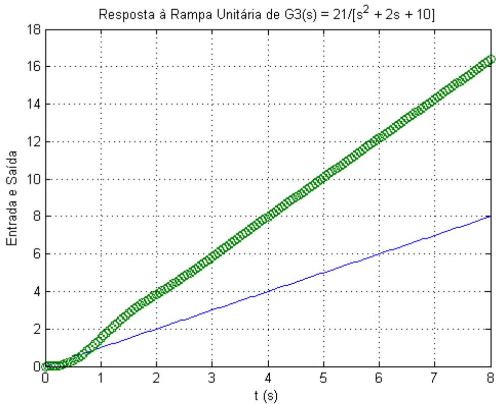
**Figura 14** – Resposta do sistema à Rampa Unitária
