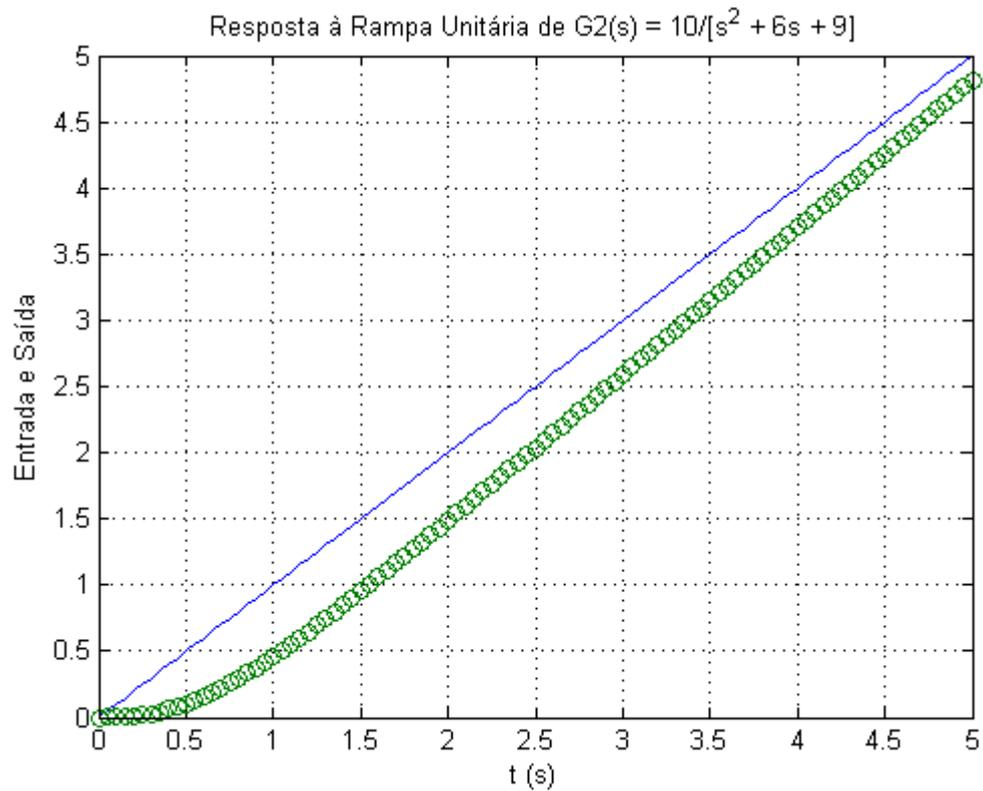
**Figura 8** – Resposta do sistema à entrada de Rampa Unitária
