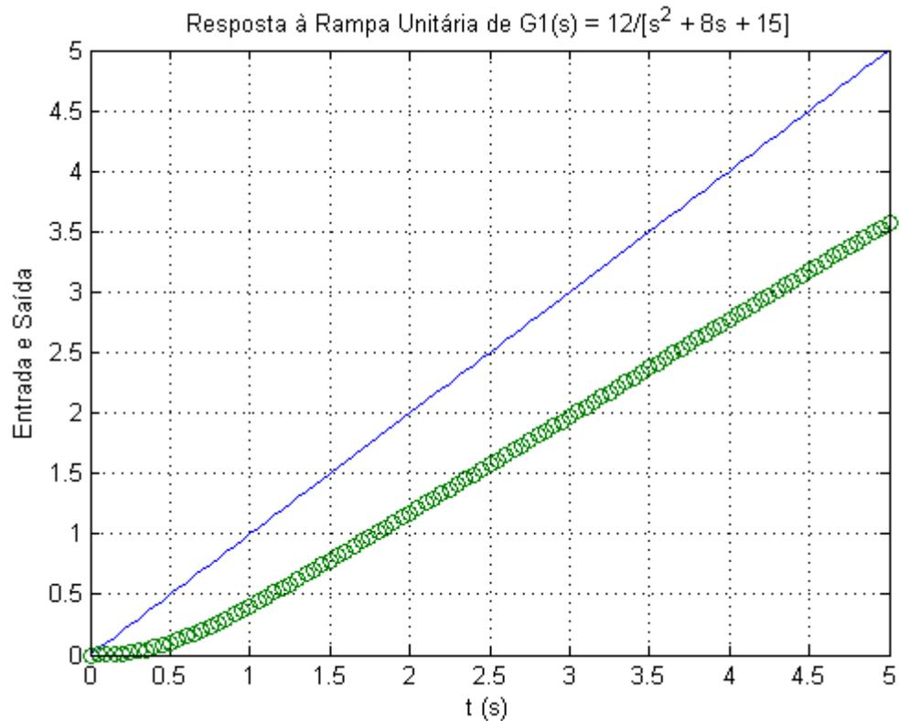
**Figura 2** - Resposta do sistema ao distúrbio à Rampa Unitária
