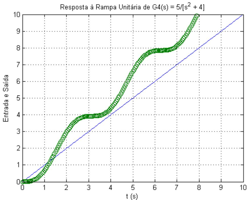
**Figura 20** – Resposta do sistema a entrada à Rampa Unitária
