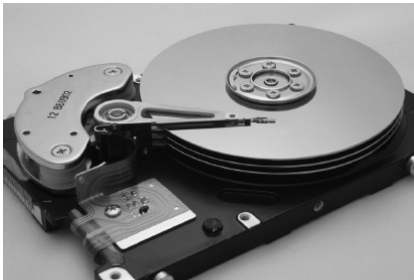
FIGURA 1.7 Acionador de disco rígido de computador mostrando o disco e a cabeça de leitura/gravação.
