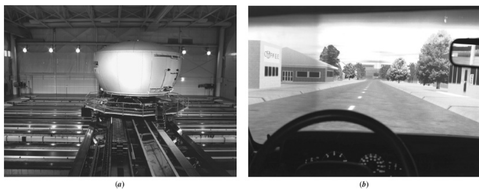
FIGURA 11.10 a. O National Advanced Driving Simulator na Universidade de Iowa; b. teste de condução no simulador com seus gráficos realistas (Katharina Bosse/laiif/Redux Pictures).
