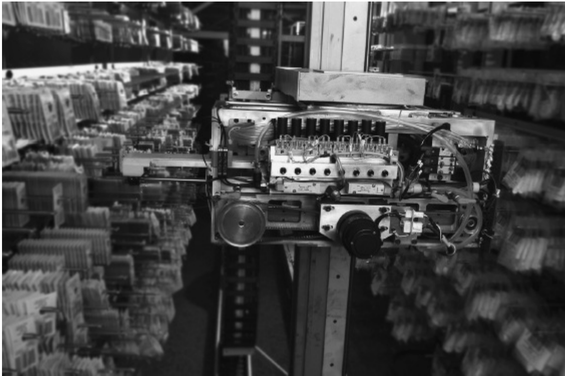
FIGURA 12.1 Um robô em uma farmácia hospitalar seleciona medicamentos através de código de barras.
