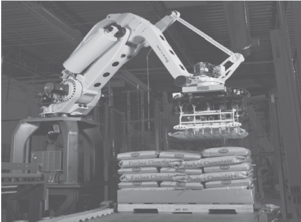
FIGURA 6.11 O FANUC M-410iB™ tem quatro eixos de movimento. Ele é visto aqui movendo e empilhando sacas de chocolate.
