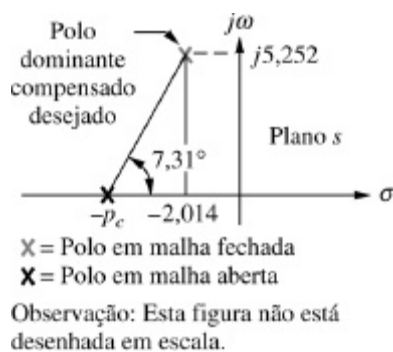
FIGURA 9.27 Diagrama no plano s utilizado para calcular a posição do polo do compensador para o Exemplo 9.4.
