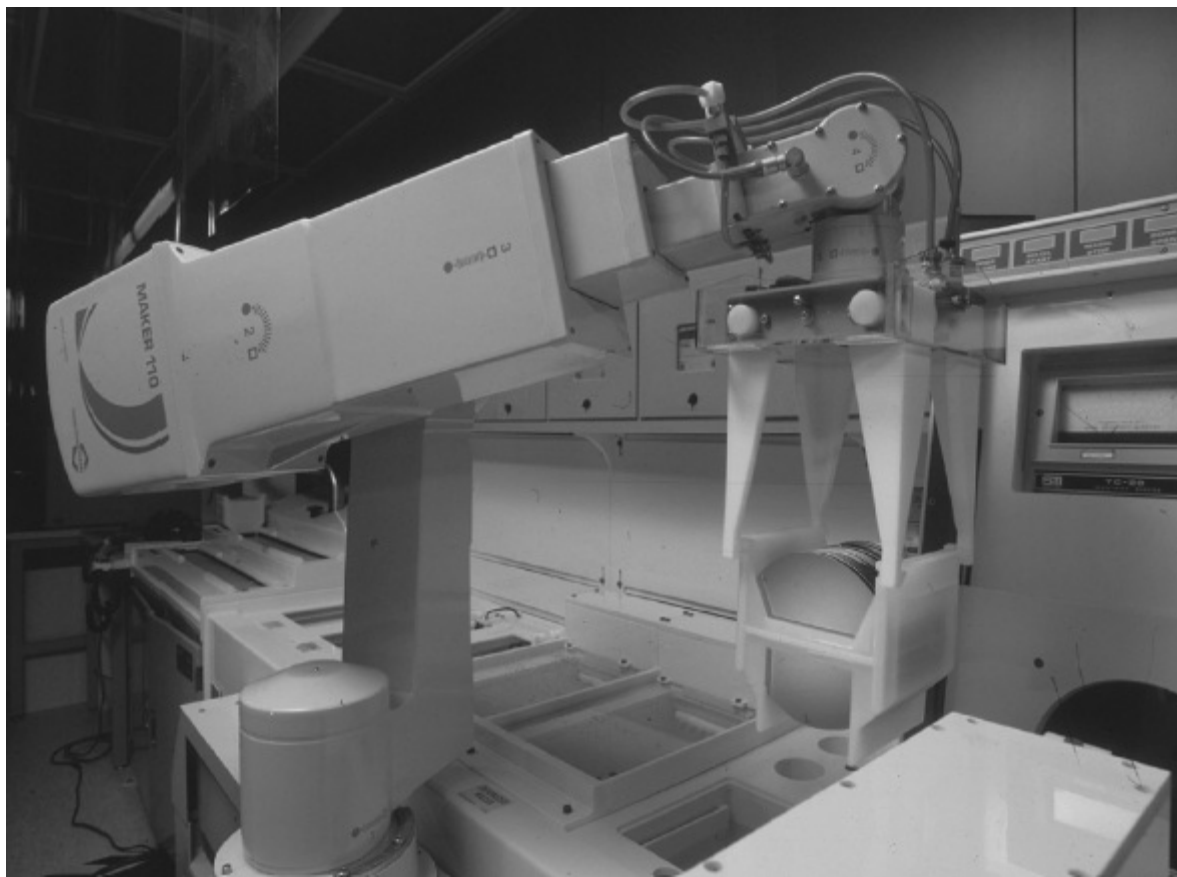
FIGURA 7.9 Um robô utilizado na fabricação de memórias de acesso aleatório (RAMs) de semicondutor, semelhantes às utilizadas em computadores pessoais. O erro em regime permanente é um aspecto de projeto importante para robôs de linha de montagem.
