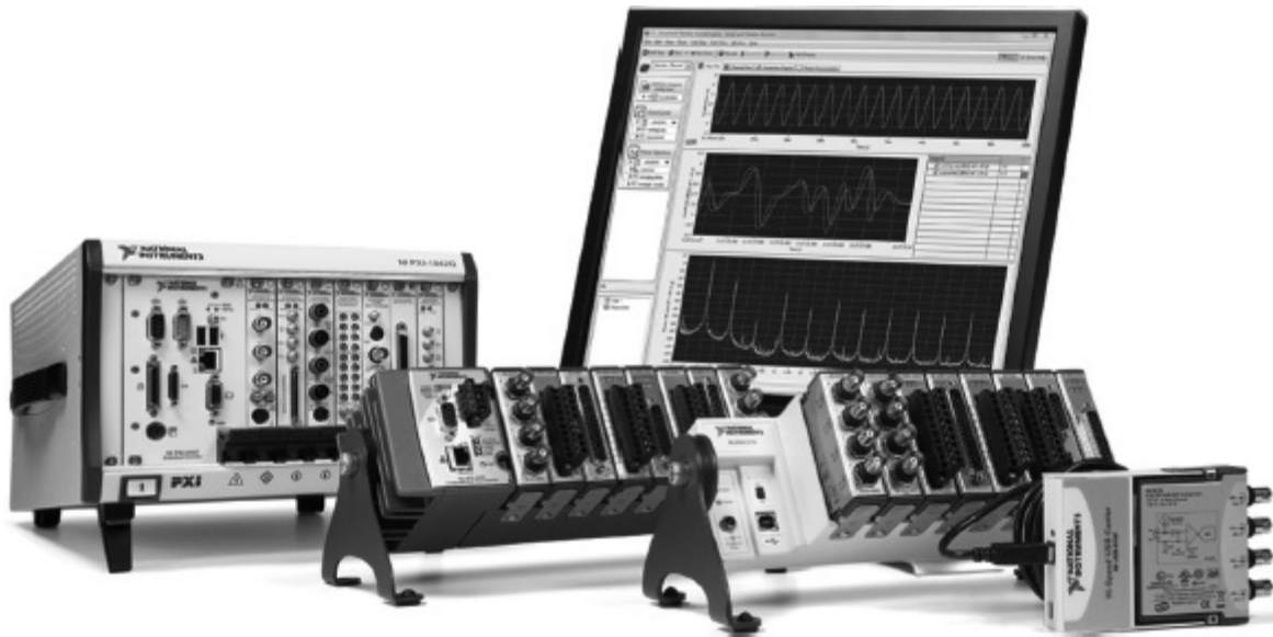
FIGURA 10.1 As plataformas National Instruments PXI, Compact RIO, Compact DAQ e o dispositivo USB (mostrados da esquerda para a direita) se unem ao programa NI LabVIEW para fornecer estímulos e adquirir sinais de sistemas físicos. O NI LabVIEW pode então ser utilizado para analisar os dados, determinar o modelo matemático e criar um protótipo e implementar um controlador para o sistema físico (cortesia de National Instruments © 2010).
