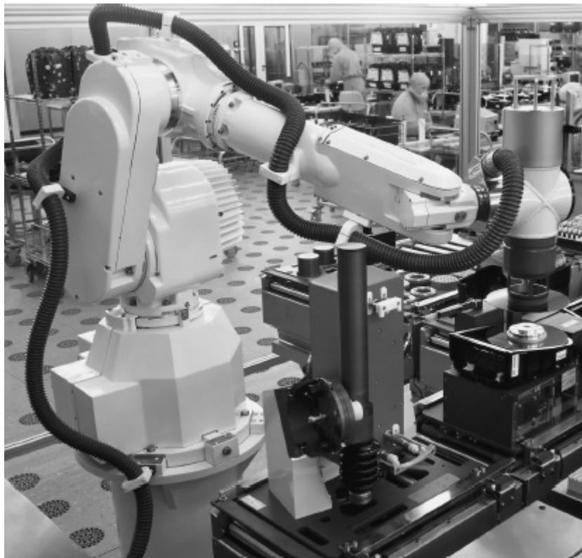
FIGURA P10.14 Robô fabricando unidades de memória de computador (© Michael Rosenfield/Science Faction/© Corbis).
