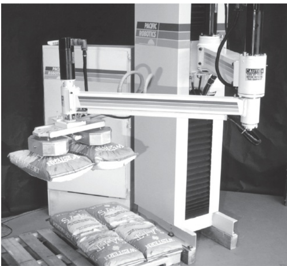
FIGURA P4.11 Um robô com atuação a vácuo suspende duas sacas de sal.
