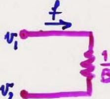
$f = K(\dot{y}_1 - \dot{y}_2) = K(v_1 - v_2)$
