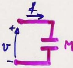
$f = \frac{v_1 - v_2}{1/B} = B(v_1 - v_2)$
