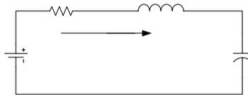
Para esse obter um modelo matemático do circuito, aplicam-se as leis dos circuitos eléctricos: de Ohm, de Kirchoff, do condensador e da bobina.
