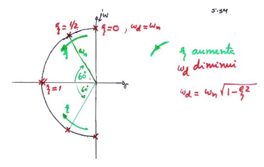
A frequência natural amortecida depende desses dois parâmetros. Como se vê na figura, se  $\xi$  aumenta, os pólos aproximam-se do eixo real e  $\omega_d$  diminui.
