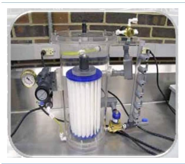
Reator de fluxo por gravidade utiliza uma barreira porosa tendo tamanhos de poros médios de cerca de 1 a 50 mícrones através da qual a água permeia sob a pressão da gravidade.
