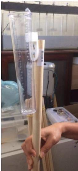
FIGURA 5 – PLUVIÔMETRO DE ACRÍLICO
