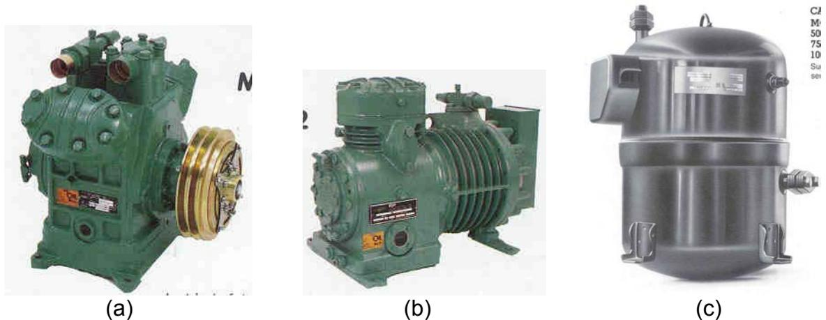
No compressor semi-hermético, a carcaça exterior aloja tanto o compressor propriamente dito quanto o motor de acionamento, como pode ser observado na (fig. 39b). Nesse tipo, que opera com compostos halogenados, o refrigerante entra em contato com o enrolamento do motor, resfriando-o. Esse compressor deve sua denominação ao fato de permitir a remoção do cabeçote, tornando acessível o compressor (válvulas, pistões, etc.) ou motor.
