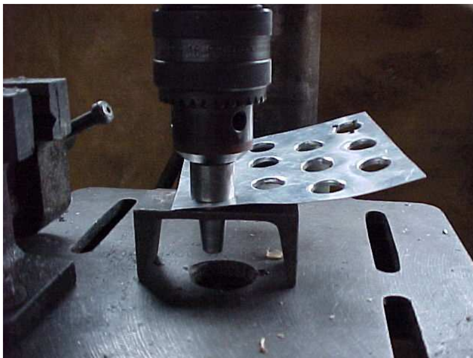
FIGURA 22 - CORTE DOS PRÉ-FUROS ELÍPTICOS DAS ALETAS
