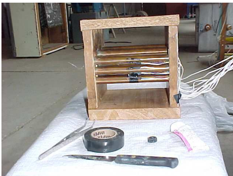
FIGURA 29 - VISTA FINAL DA INSTALAÇÃO DOS TERMISTORES
