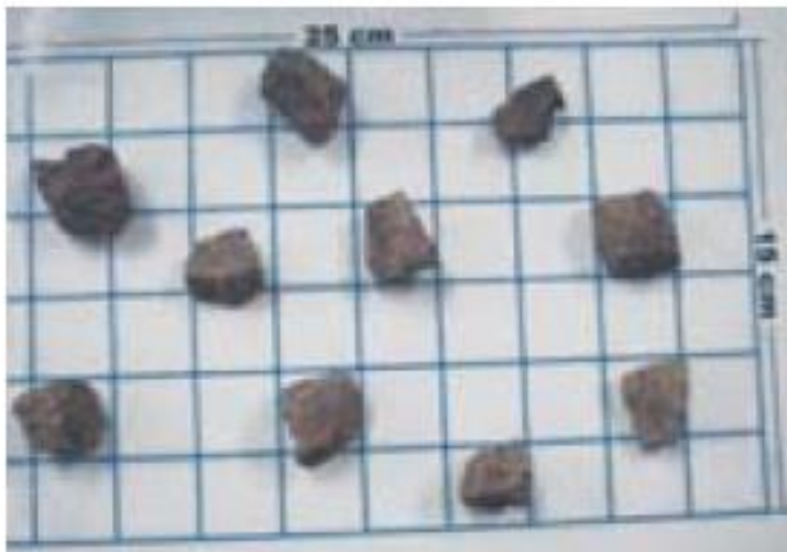
Foto 14 - Exemplos de estrutura grande em blocos angulares
