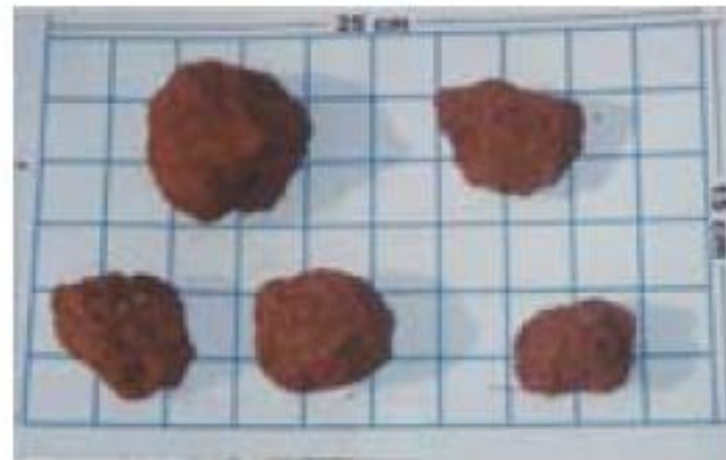
Foto 16 - Exemplos de estrutura muito grande em blocos subangulares
