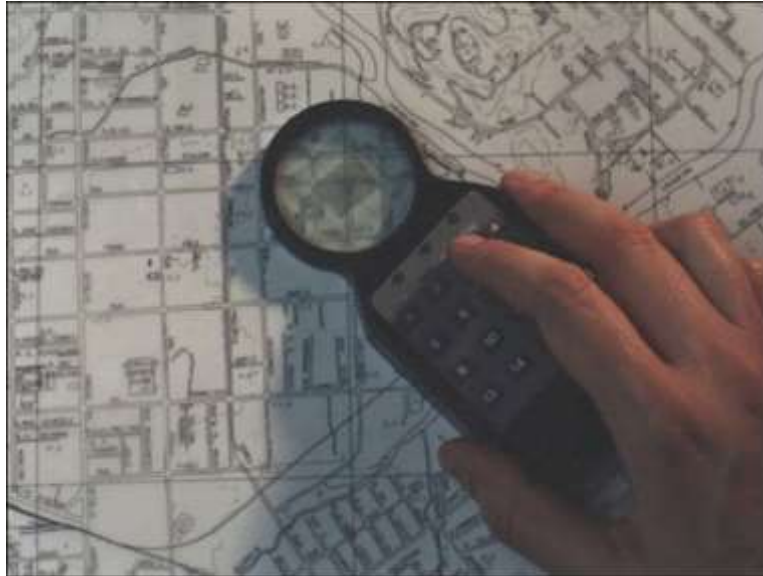
Cursor sobre mesa digitalizadora (s. r.)
